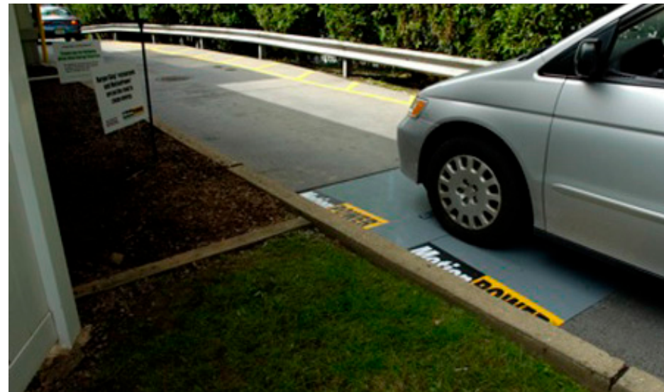
Energie opwekkende verkeersdrempel
